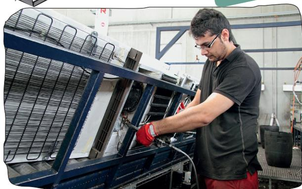
Absaugen des Kühlkreislaufs (mittels Vakuumpumpe)
